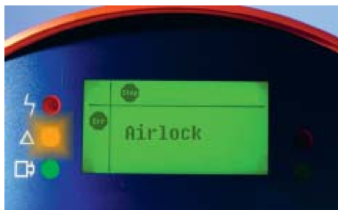
Bild 2: Der Antrieb selbst detektiert hydraulische Störungen wie Überdruck oder Brüche in der Dosierleitung sowie Gaseinschluss (Airlock) im Dosierkopf
