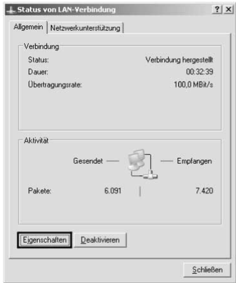
Abb. 4: Status von LAN-Verbindungen
