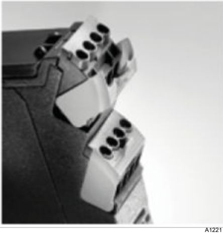
Abb. 2: Montage / Demontage der Anschlussstecker (Detail Ansicht)
